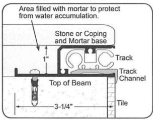
TRACK CHANNEL ON TOP OF BEAM FILLED BEHIND TRACK CHANNEL
